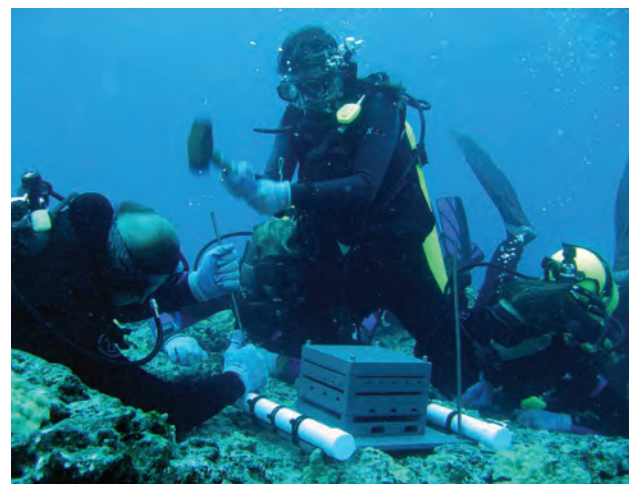
8. Les structures autonomes de coraux artificiels pour le suivi des coraux tropicaux, de sont petites boîtes en PVC percées de nombreux petits trous et dans lesquelles les invertébrés, tels que les crabes et les mollusques, peuvent nicher. Elles sont conçues de manière à imiter l'environnement des récifs, et après une année ou deux, les boîtes sont retirées des récifs et étudiées pour identifier les organismes qui se sont installés à l'intérieur et sur celles-ci. Source: Andy Collins, National Oceanic and Atmospheric Administration
