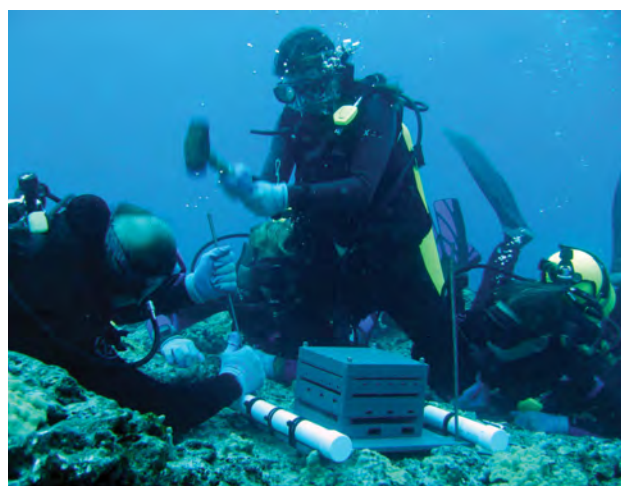
8. 「Artificial Reef Monitoring Structures (人工サンゴ礁監視システム)」は、ポリ塩化ビニル製の小箱で、カニや軟体動物などの無脊椎動物が棲めるように、小さい穴が多数空いています。このシステムは、サンゴ礁の環境を再現するために考案され、1~2 年後に箱をサンゴ礁から撤去して、箱の中や上にどのような生物が定着したかを確認する調査を行います。出典: 国立海洋大気圏局、Andy Collins (アンディ コリンズ)
